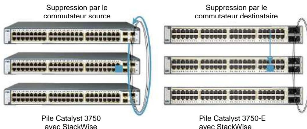
2. StackWise Plus peut commuter localement les paquets, alors que StackWise ne le permet pas. Avec StackWise, tous les paquets, même ceux ayant une destination locale sur le même commutateur, doivent traversés l'anneau complet (Figure 10).
