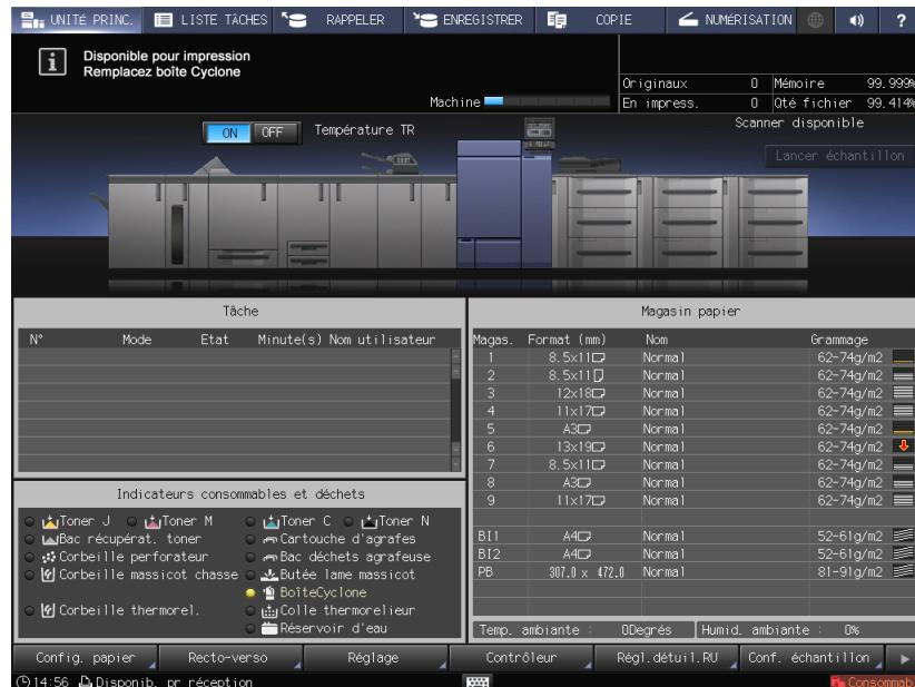
Lorsqu'il est impossible de continuer l'impression parce que la **boîte Cyclone** doit être remplacée, le message [Veuillez remplacer la boîte cyclone] s'affiche. Suivez la procédure ci-dessous pour remplacer la **boîte Cyclone**.
