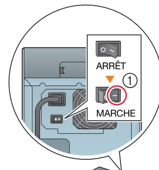
→ Pour le **contrôleur image IC-315**, mettez l'**interrupteur** à l'arrière en position Marche (①), puis appuyez sur le **bouton d'alimentation** à droite (②).
