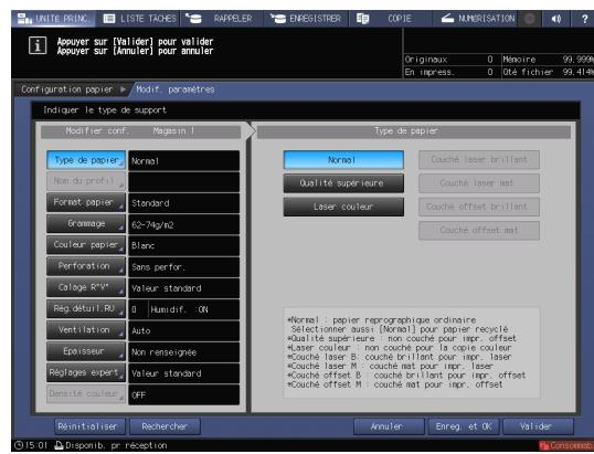
**5** Sélectionnez l'une des options sous [Configuration Format] pour correspondre au papier chargé dans le magasin.
