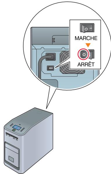
Pour le **contrôleur image IC-315**, mettez l'**interrupteur** à l'arrière en position Arrêt.
