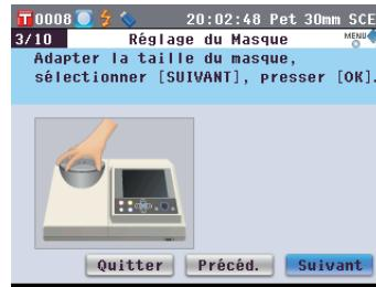
9. Fixez le masque cible optionnel (pour boîte de Pétri) si le diamètre de 30 mm a été sélectionné ou bien le masque cible optionnel (pour mini-boîte de Pétri) si le diamètre de 3 mm a été sélectionné à l'étape 6 mentionnée ci-dessus.
