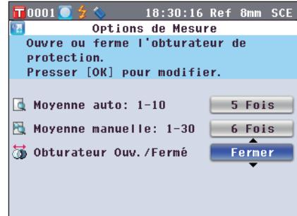
2. Utilisez les touches **▲** et **▼** pour indiquer si l'obturateur doit être ouvert ou fermé.
