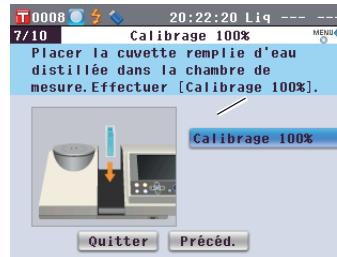
11. Lorsque le calibrage à 100% est terminé : Si aucun support mémoire USB n'est connecté, l'écran <Réglage Conditions mesure OK> s'affiche. Passez à l'étape 12.
