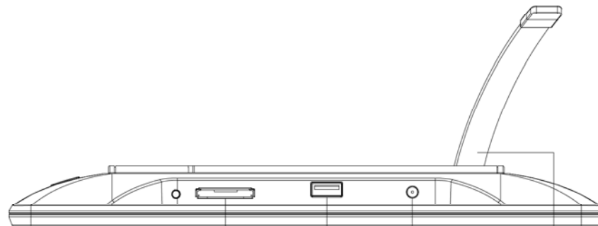
Puerto para tarjetas SD/MMC, MS Puerto USB para llaves Entrada de alimentación Base
