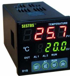
Si l'on choisit un modèle qui possède un relais, on sélectionnera un relais capable de supporter au moins 10A continu, car la consommation de la résistance de chauffe est « faible » : 2A, le lit chauffant, par contre, peut consommer un peu plus de 10A au démarrage !
