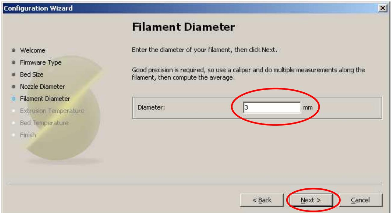
Saisir le diamètre de votre jonc (filament) d'ABS ou PLA. Attention, il ne faut pas saisir 3 mm ou 1.75 mm mais bien la cote réelle du jonc que vous allez utiliser ! En effet, Slic3r fera les compensations nécessaires entre le diamètre du jonc, les vitesses d'avance, ... pour déterminer le débit d'extrusion (flow) nécessaire lors de l'impression.
