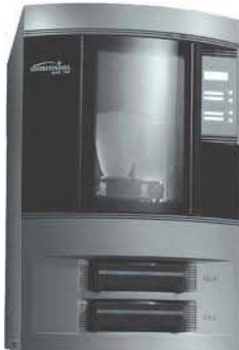
Volume de construction : 200 x 200 x 250mm (x,y,z)
