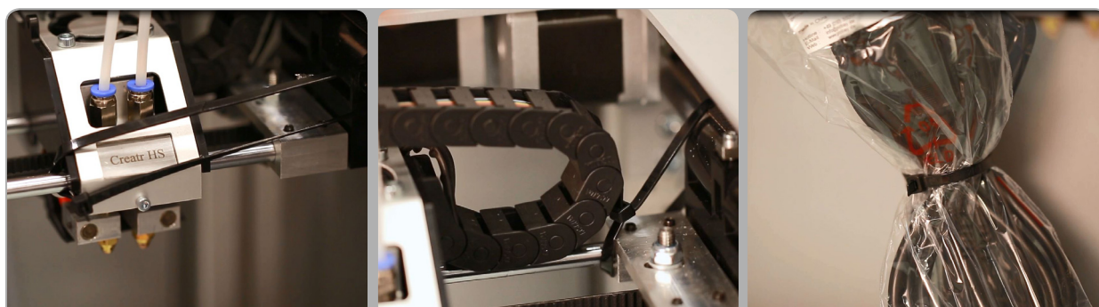
ÉTAPE 4: Coupez les tie cords à l'avant et à l'arrière du carriage, et aussi à l'arrière de l'imprimante
