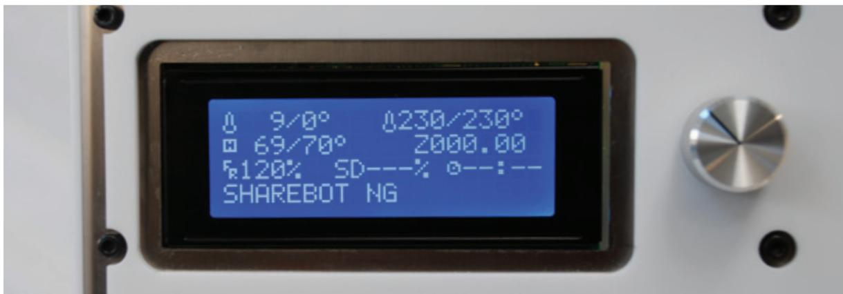
La première ligne contient la température réelle de l'extrudeur, suivie par la consigne. Dans le cas de deux extrudeurs le premier est à gauche et le second à droite. Là, elle est utilisée avec l'extrudeur principal de droite. La température est en degrés Celsius. La deuxième ligne indique à gauche la température de la plaque chauffante si elle est présente.
