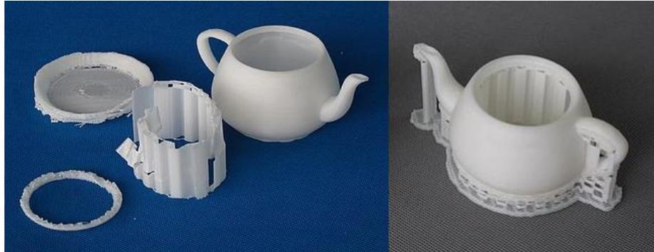
Les modèles imprimés sont composés de deux parties. La première est le modèle lui-même, et l'autre le matériel de support utilisé pour soutenir les parties en surplomb du modèle.
