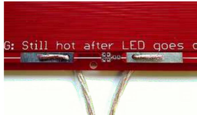
Souder 2 fils de longueur 80cm (section mini 1mm<sup>2</sup>), ne pas hésiter à charger en soudure, le courant est supérieur à 10A
