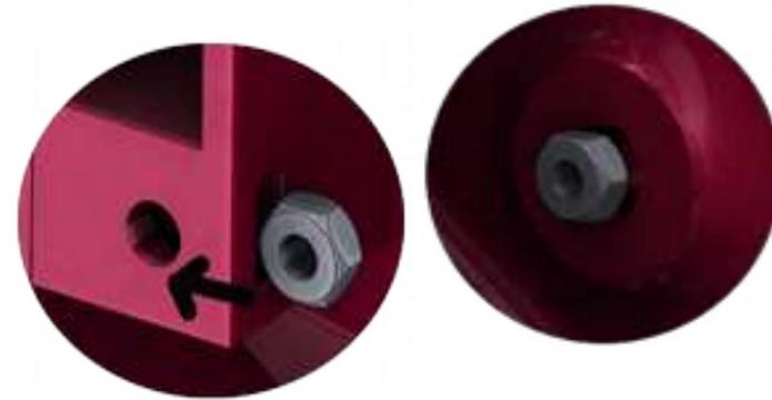
PROTECT-POWER fixé par 1 vis CHC M3x12 sur le LEFT-SIDE, 1 vis FHC M3x12 sur le FRAME et 2 écrous M3
