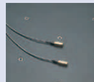
Sondes de température pour système de compensation thermique
