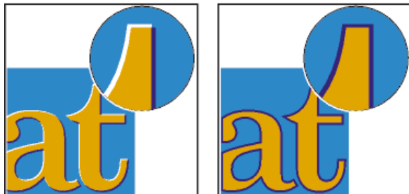
Problèmes de repérage des encres sans recouvrement (à gauche) et avec recouvrement (à droite)
