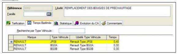
Pour cette opération de main-d'œuvre, sur les véhicules de type JP08 Renault, 0.40 heures seront nécessaires pour effectuer la pose contre 0.30 pour les autres véhicules.
