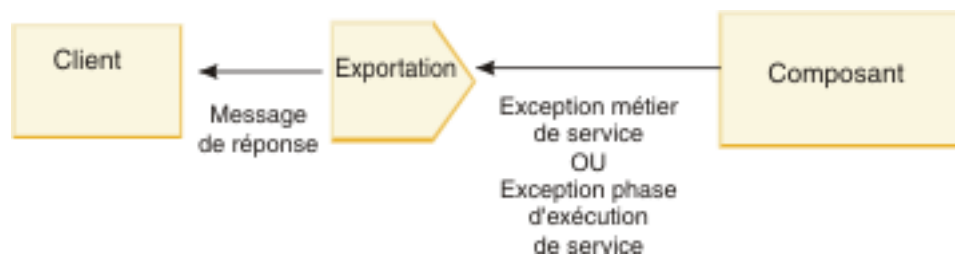
Figure 12. Manière dont les informations sont envoyées du composant vers le client via la liaison d'exportation
