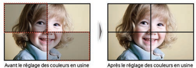
Figure 3. La comparaison côte à côte montre de quelle façon le réglage des couleurs en usine améliore l'uniformité des couleurs dans l'ensemble de la vidéomosaïque.
