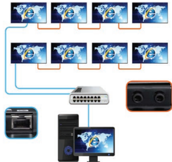
Figure 11. Les écrans des séries UDC et UEC permettent une connexion RJ45 et RS-232C simultanée.
