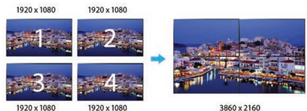
Figure 6. Les écrans des séries UDC et UEC offrent une ultra-haute définition de 3860 x 2160 pixels pour une vidéomosaïque 2 x 2 écrans.
