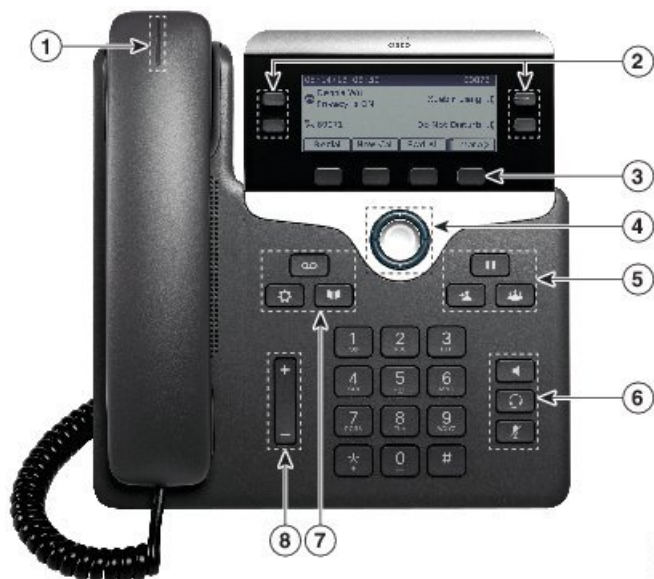
Illustration 3 : Touches et fonctionnalités des téléphones IP Cisco série 7800
