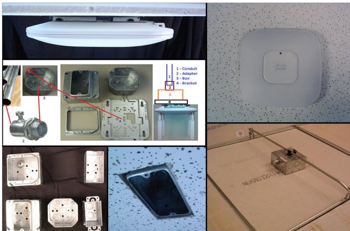
図 65. AP を電気コンジットボックス（天井の T バーまたはコンジット）に取り付ける
